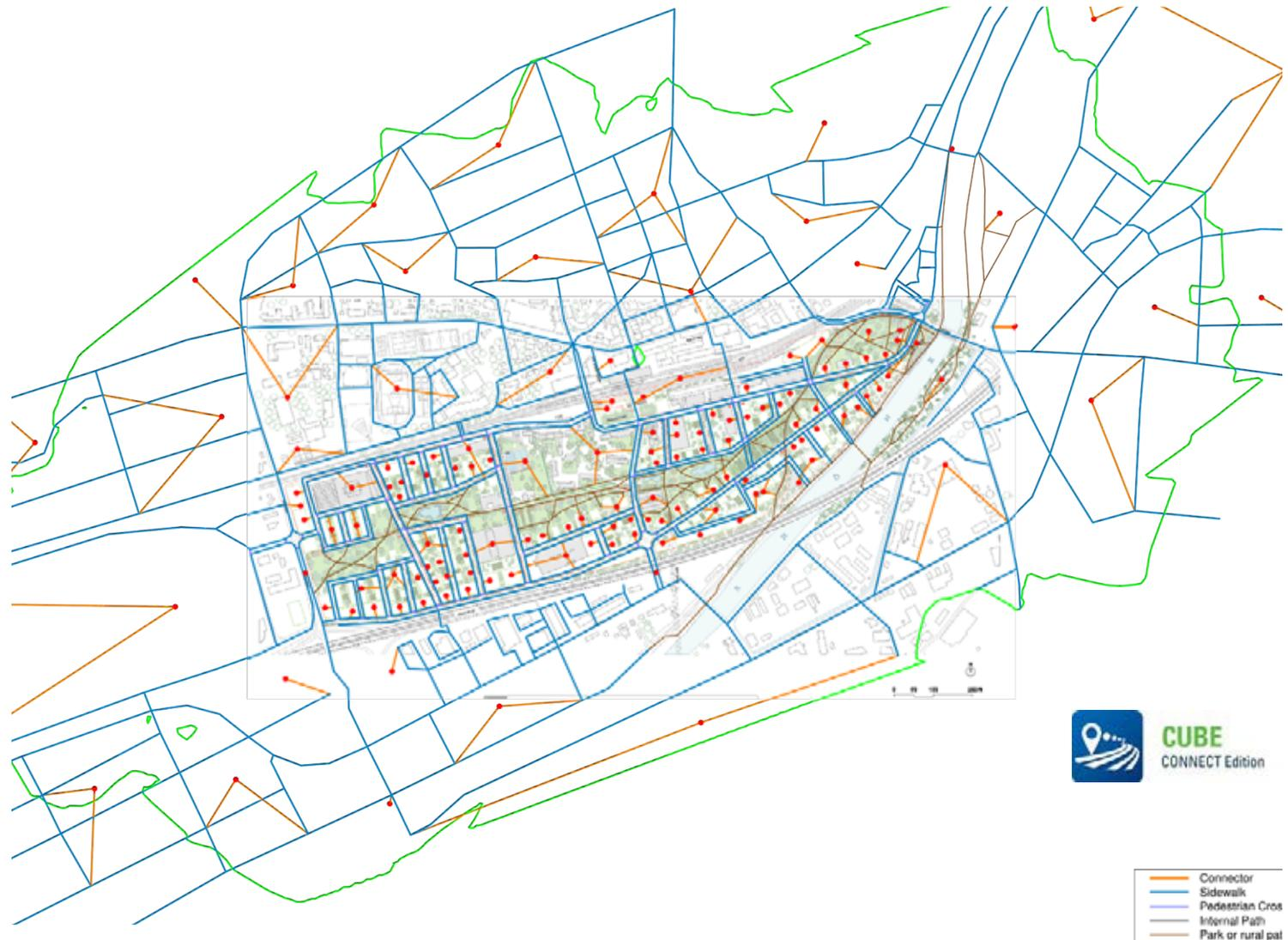
Modèle de simulation des flux piétons
