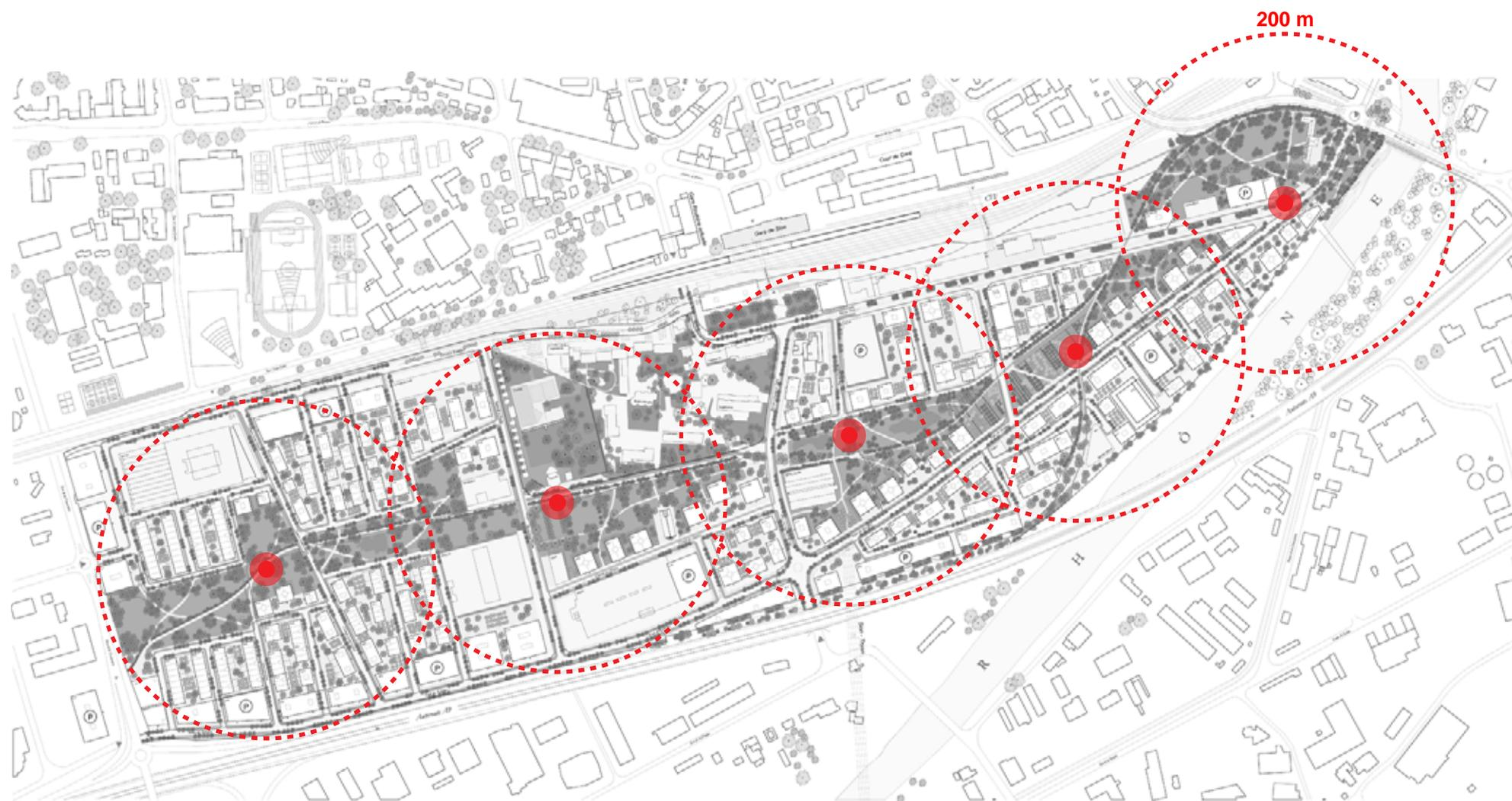
B4.49 Schéma de principe : gestion des déchets
